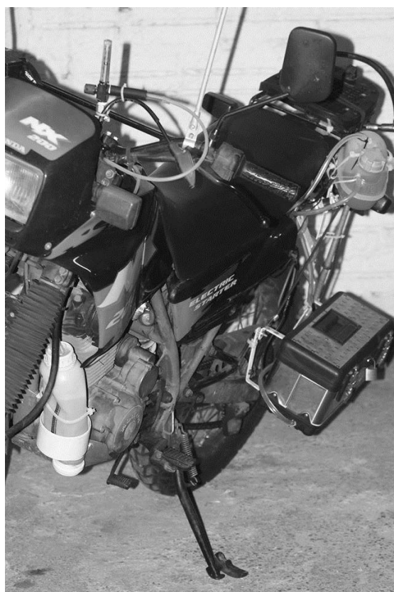
На фото: установлен электролизер и дополнительный внешний аккумулятор
