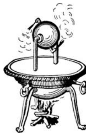
Рисунок 1. Паровая турбина Герона Александрийского.
