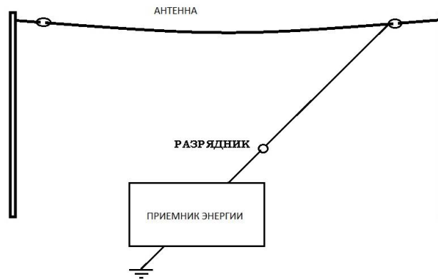
Рис. 194. Эксперимент Моря с антенной.
