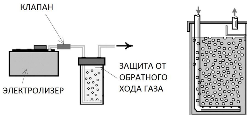
Рис.232. Особенности подготовки водно-газовой смеси. Схема с сайта www.free-energy-info.com
