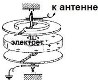
Рис. 77. Электростатический мотор Ефименко с электретным ротором.
