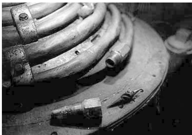
Рис. 44. Сопло на конце трубки «домашнего генератора» Шаубергера.
