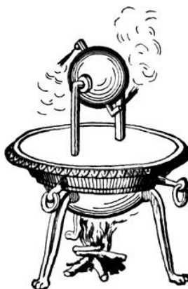
Рисунок 1. Паровая турбина Герона Александрийского.
