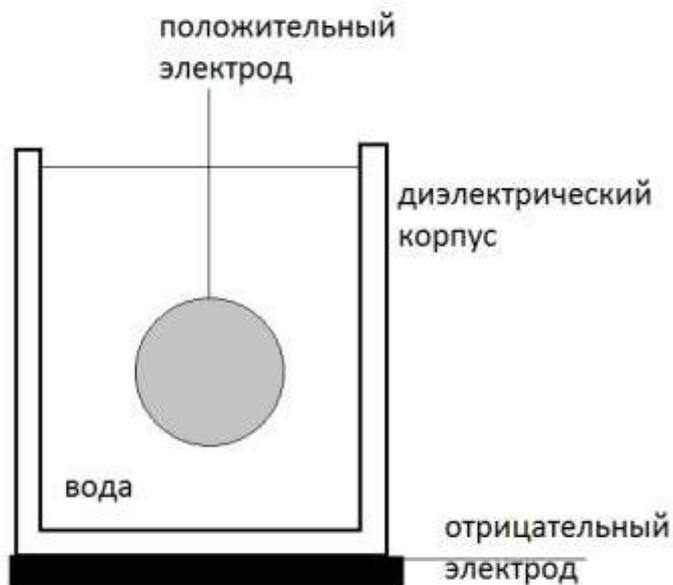
Варианты бестоковой диссоциации воды с целью получения газа (кислорода и водорода) могут использовать либо диэлектрические свойства чистой воды, либо конструктивные особенности электролизера. Дистиллированная вода является очень хорошим диэлектриком, в 81 раз лучше воздуха. Однако, ее получение требует специальных методов.
